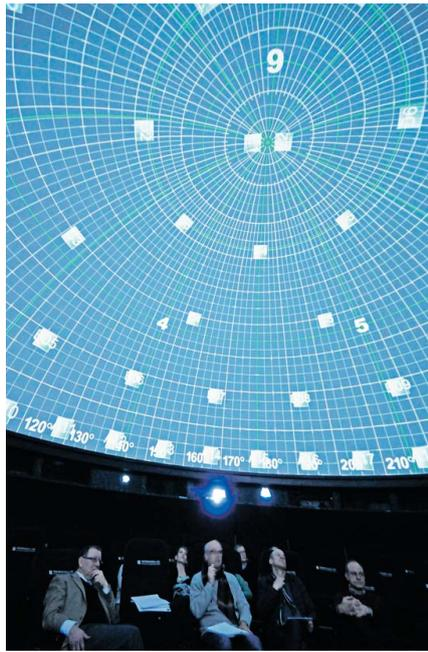
Jedes Quadrat zeigt die Position eines der Lautsprecher, die hinter der Projektionsfläche der Mediendomkuppel sitzen. Damit wird nicht nur räumliches Erleben, sondern auch 3D-Sound möglich. FOTO: KST
